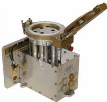
Созданный в Институте астрофизики МИФИ прибор «ФОКА» изучал ультрафиолетовое излучение Солнца и верхних слоев атмосферы Земли
